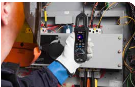
红外成像引导测量技术帮助用户发现问题
